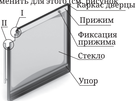
Рисунок 12. Ремонт светорозрачного экрана дверцы модели «Витра»
